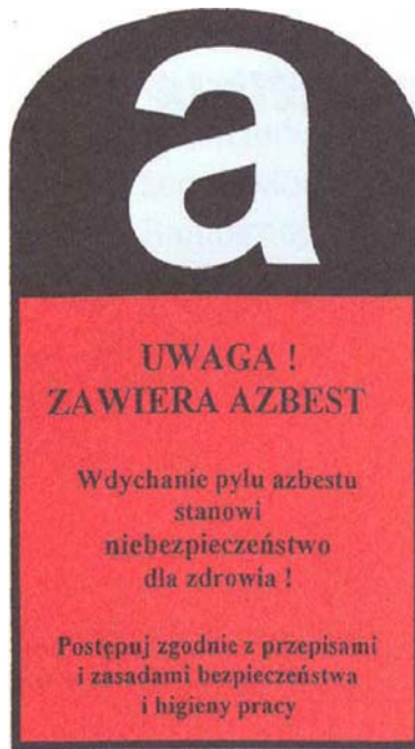
Rys. 1 Oznakowanie wyrobów i odpadów zawierających azbest, wysokość znaku powinna wynosić co najmniej 5 cm, a szerokość co najmniej 3 cm.
